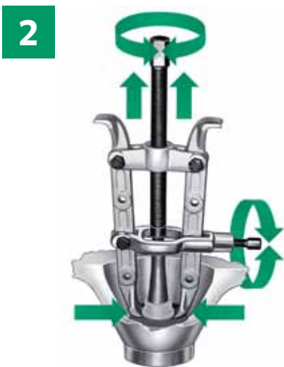
Принцип функционирования двухрычагового съемника
